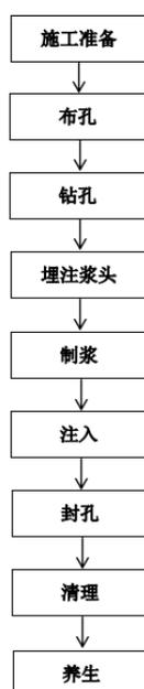
图1 注浆施工工艺流程
